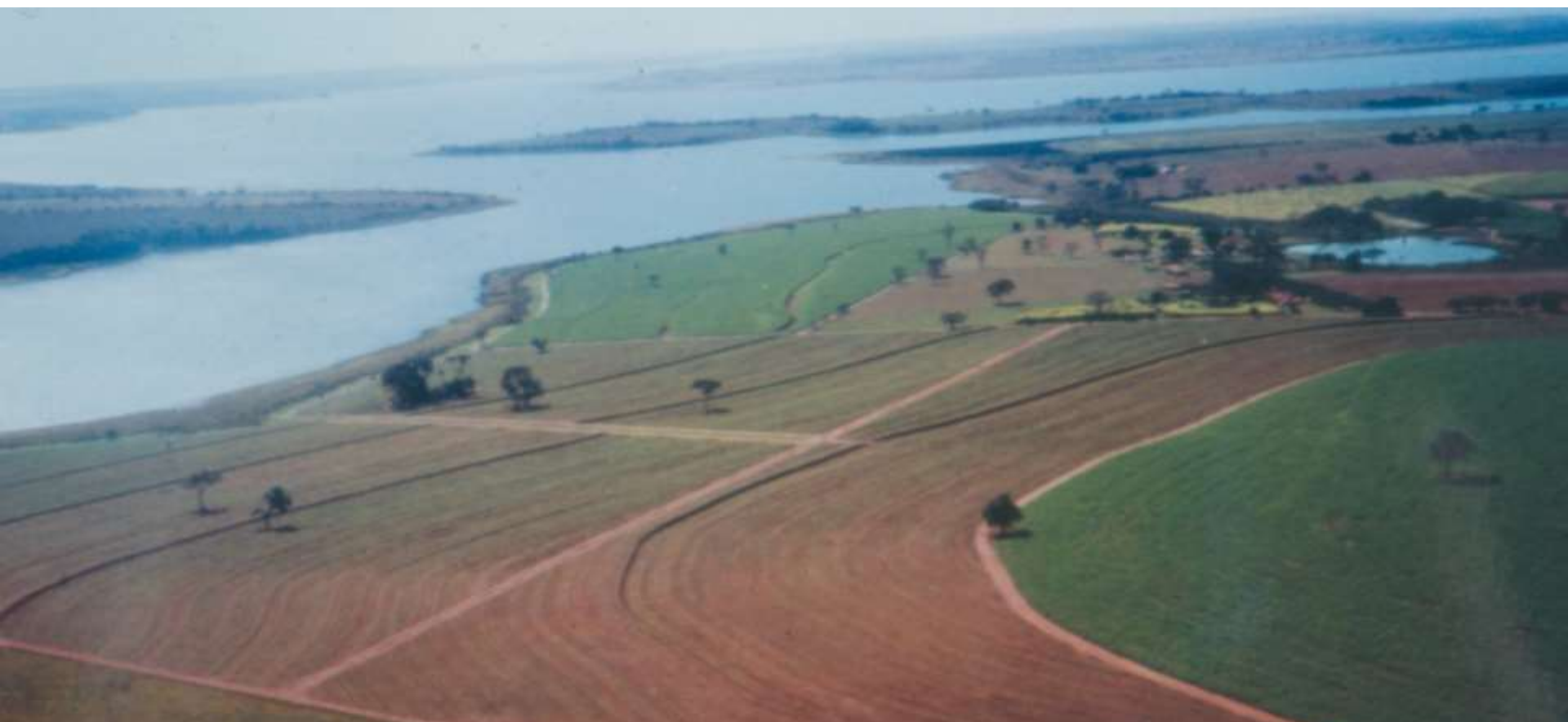
Vista lateral do terraço interceptor, canal escoadouro e terraços paralelos a jusante.
